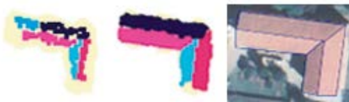
Abb. 7: Links: Aus Laserscannerdaten extrahierte Ebenen; Mitte: Verbesserung der Ebenensegmentierung durch Luftbilder; rechts: mit Luftbilddaten verbesserte Randpolygone [8].
